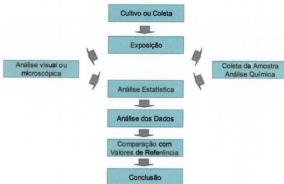
Fig. 16 As etapas principais do uso de plantas bioindicadoras no monitoramento da qualidade do ar (KLUMPP et al, 2001)
